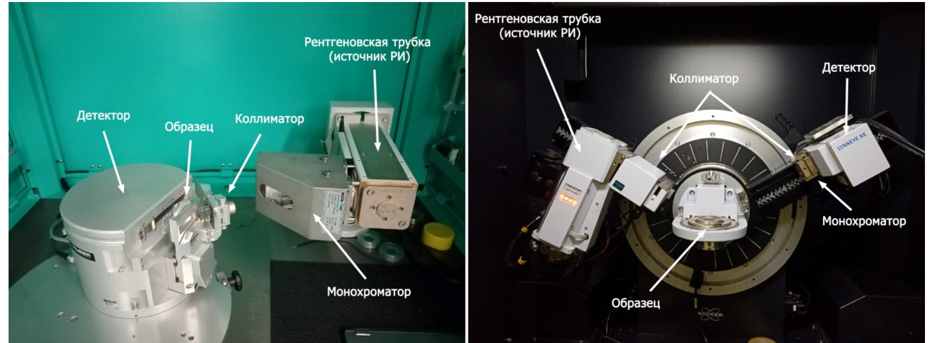
Дифрактометры Huber G670 (слева) и Bruker D8 Advanced (справа) с различной геометрией взаимного расположения узлов
